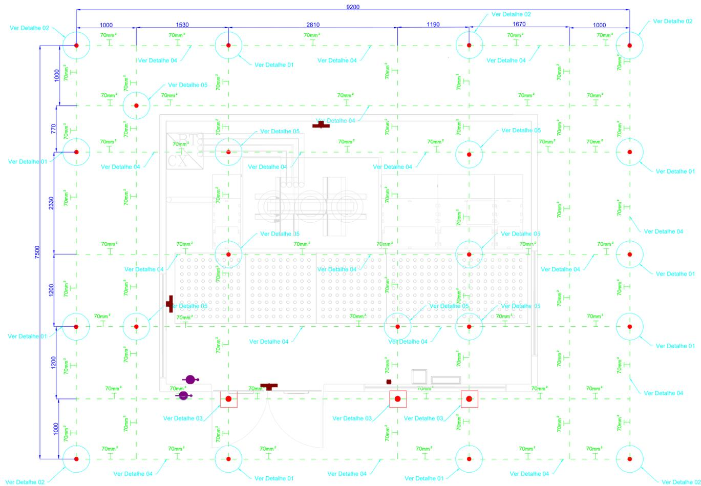
Detalhe da Malha de Aterramento – Disposição das Hastes
