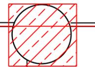
DEMOLUÇÃO DE BASE EM CONCRETO E REMOÇÃO DA CAIXA D'ÁGUA. DIMENSÕES: 1,67 X 1,80 X 0,17 M
