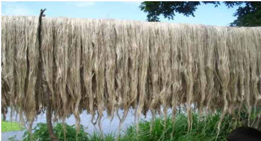
Figura 1 – Amostra de Fibra extraída do Sisal
