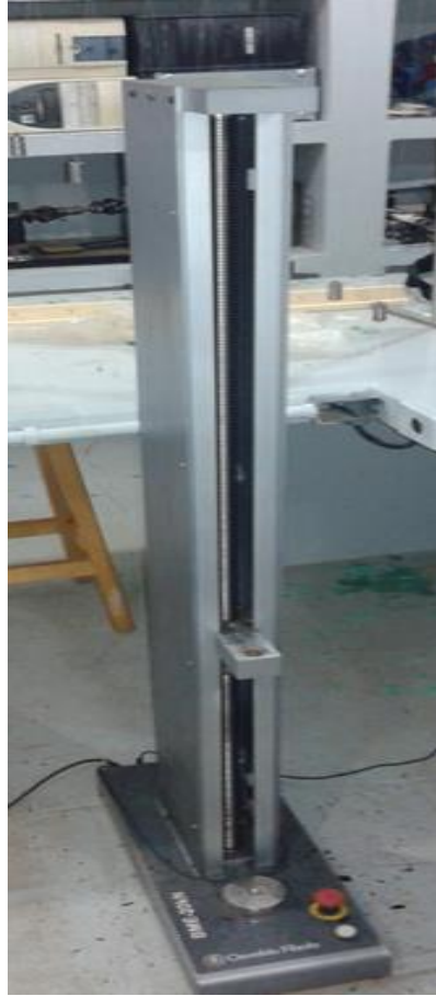
Figura 5 – Máquina de Ensaio de Tração
