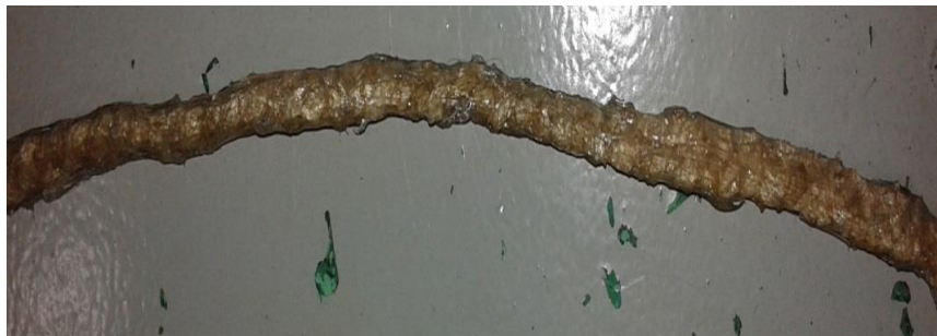
Figura 4 – Amostra da Fibra Adicionado Silicone
