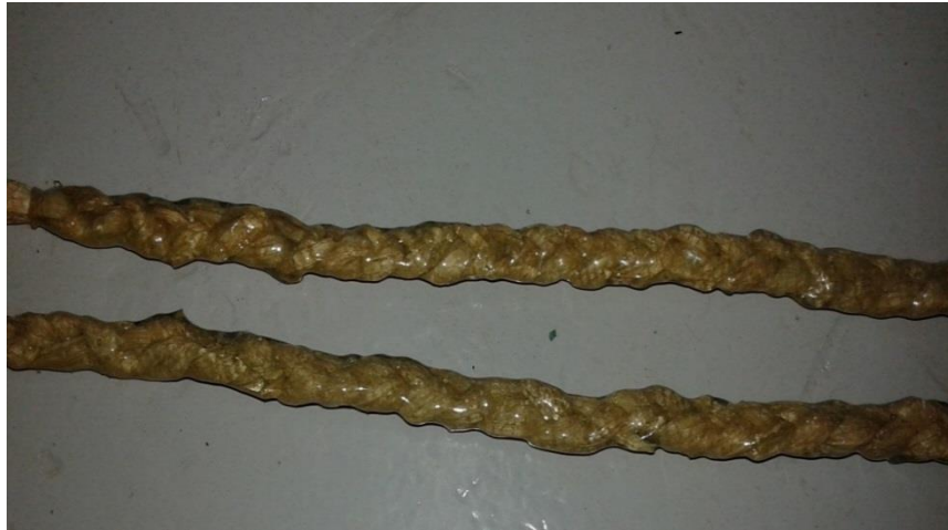
Figura 3 – Amostra da Fibra Adicionado Epóxi
