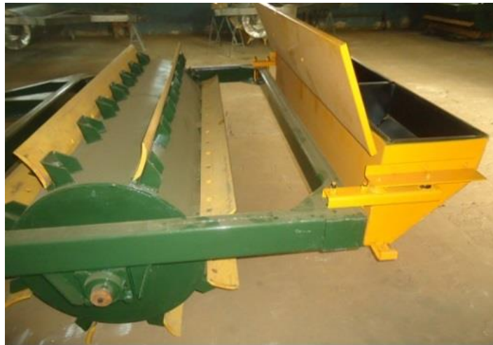
FIGURA 4 - Semeadeira de capim acoplado ao RoloFort.
