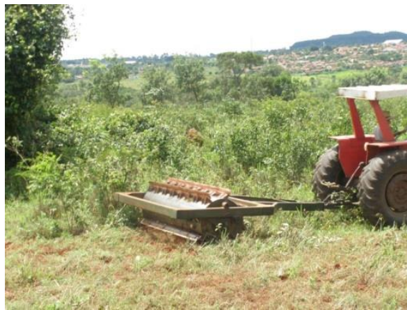
FIGURA 2 - Processo de trituração da capoeira com cilindro desbravador da Rolofort.
