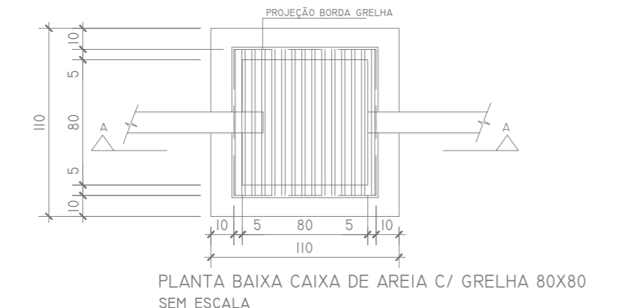
DETALHE CAIXA DE AREIA ESGOTO PLUVIAL 80X80CM
