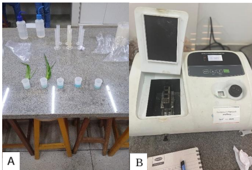
FIGURA 2 - Lavagem dos coletores (a) e leitura da absorbância das amostras no espectrofotômetro (b).
