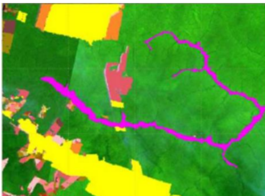
FIGURA 4 - A máscara do PRODES 2010 com os desmatamentos antigos já detectados (amarelo e tons de marrom) e áreas de não-floresta (magenta), sobreposta à composição colorida do Landsat de 2010
