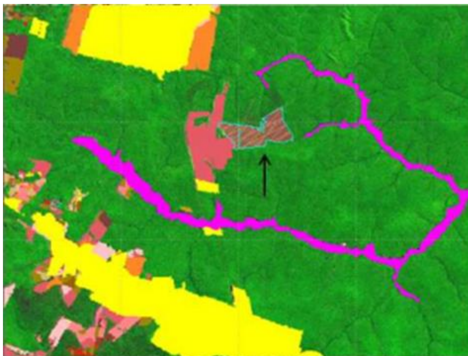
FIGURA 5 - A máscara do PRODES 2010 é então sobreposta à imagem em composição colorida do Landsat de 2011. A seta mostra área com evidência de novo desmatamento por corte raso que inexistia na imagem do ano de 2010 e consequentemente na máscara
