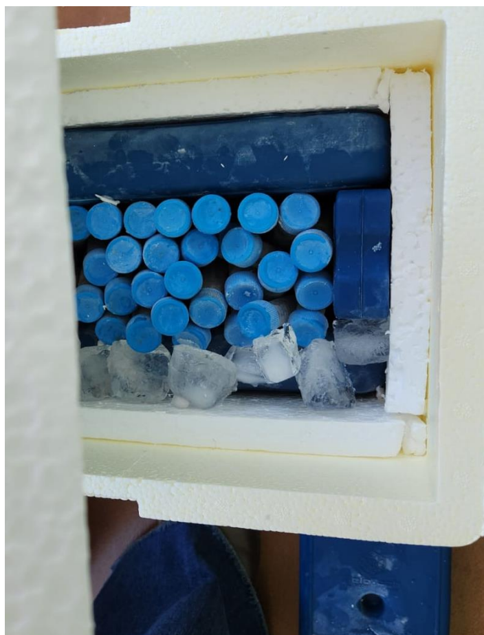
IMAGEM 7 - Caixa térmica com isopor, gelo seco e gelo comum, utilizada para armazenamento provisório do solo rizosférico, durante o procedimento de coleta das amostras.
