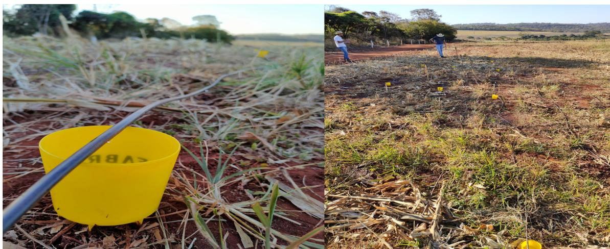
Figura 4 - Teste de uniformidade de irrigação na área experimental no município de Rio Verde-GO.
