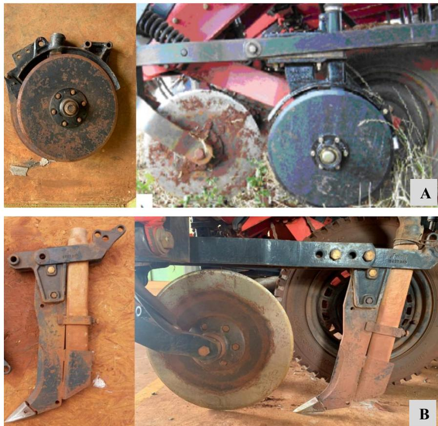
Figura 2 - Imagens dos mecanismos de abertura do tipo discos duplos (a) e hastes sulcadoras (b).
