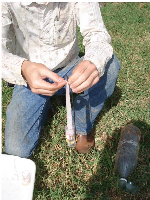
ANEXO 3. Tubo de polietileno com espuma imersa em solução de  $H_2SO_4$  + Glicerina e fixada na haste para coleta de  $NH_3$ .
