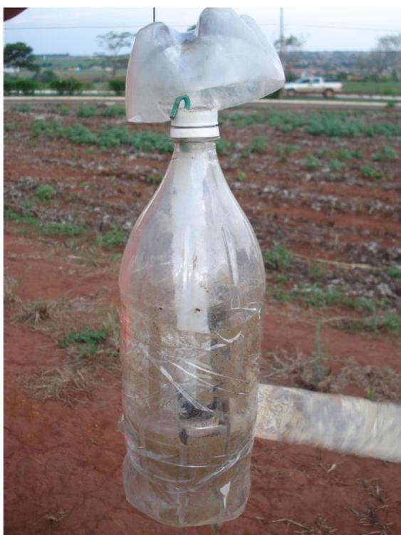
ANEXO 7. Garrafa PET fixada no solo contendo tubo de polietileno com espuma imersa em solução de  $H_2SO_4$  + Glicerina em seu interior para coleta de  $NH_3$ .
