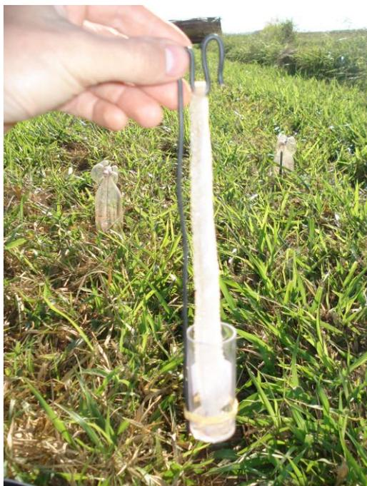
ANEXO 4. Tubo de polietileno com espuma e solução de  $H_2SO_4$  + Glicerina identificado com data, bloco e parcela.
