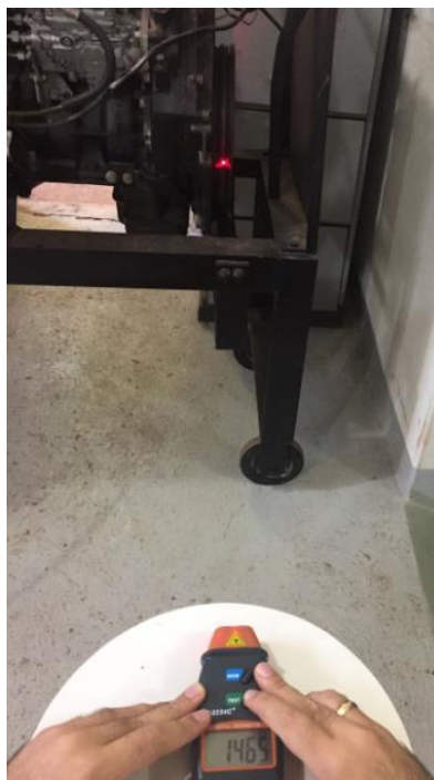
FIGURA 5 – Medição de RPM em motor estacionário
