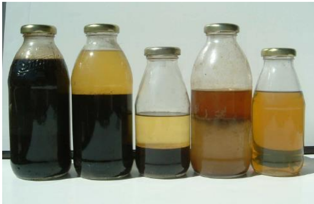
FIGURA 2 - Frascos de diesel S-10 contaminado com biomassa bacteriana em diversos estados
